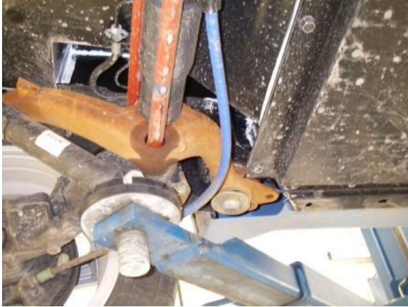
Bakre løftepunkt ved bytte av batteripakke.
