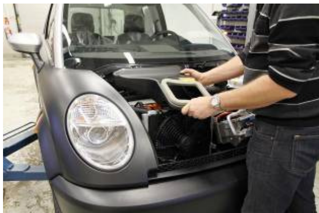
Fjern luftkanal, festet med 1 skrue
