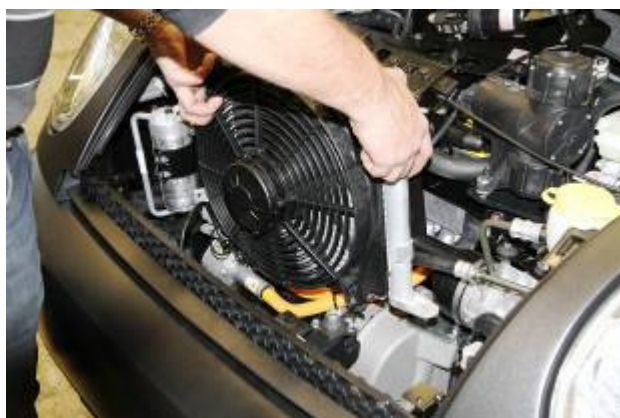
Demonter A/C kompressor og kondenser. For detaljer se kapittel F
