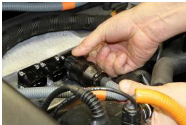
Ta av 10 pins kobling for batteriovervåkning
