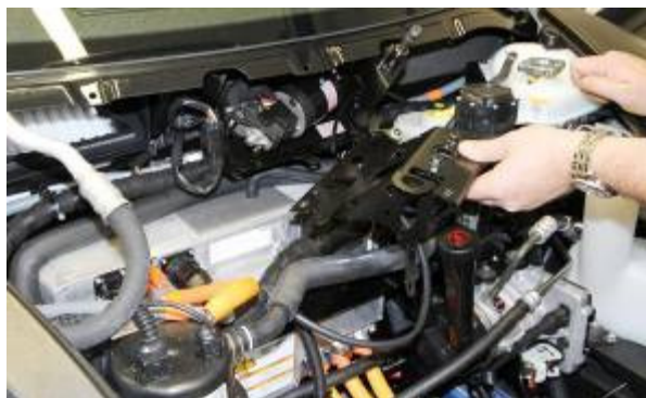
Fjern braketten for vindusviskermotor
