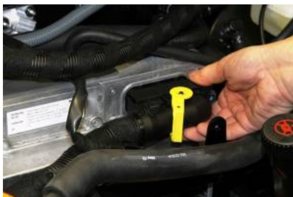
Ta av 62 pins kobling
