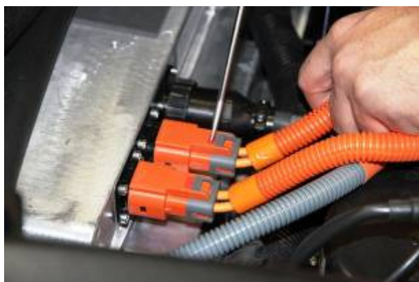
Koble fra ledninger for A/C og vannvarmer.
